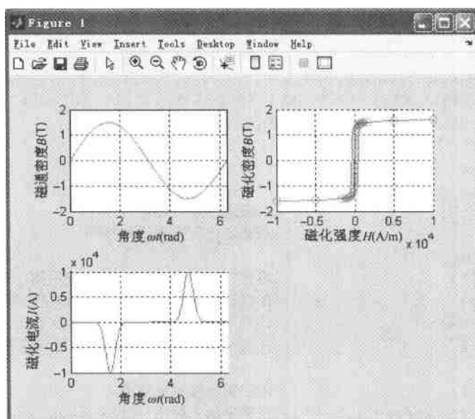
图 8-2 变压器基本磁化曲线及磁路饱和所引起的磁化电流畸变
