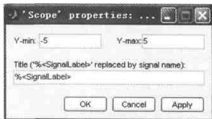
图 7-31 示波器 y 轴范围设定
